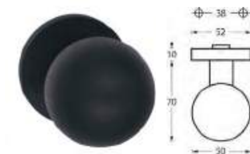
543-21 / vast Hartafstand: 38 mm Ø rozet: 52 mm Ø knop: 50 mm alleen bij vleugeloverdekkend paneel mogelijk! (montage op paneel)
